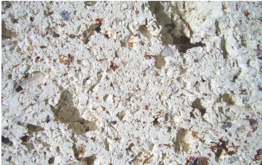
Vergrößerte Ansicht: Keramikstein im Schnitt mit Poren, Spalten und Höhlungen.
